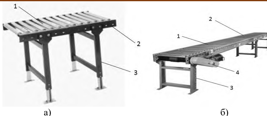
Рисунок 1 – Рольганги: а) бесприводной; б) приводной 1. Ролик; 2 – Несущая система роликов; 3- Опорная стойка; 4- Привод.
