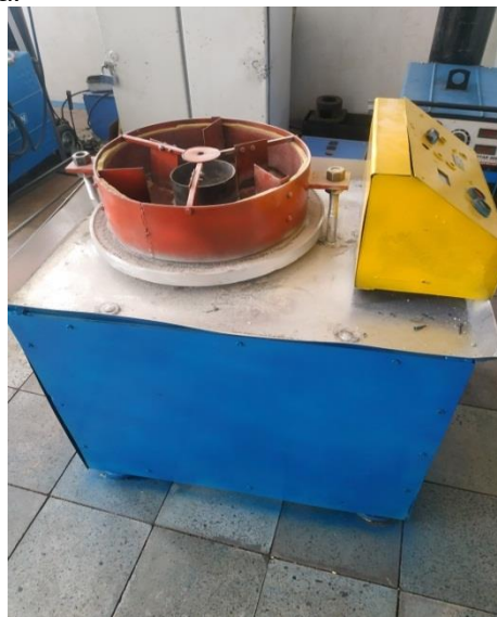
Рисунок 3. Станок для формообразования шариков из самоцветных камней
