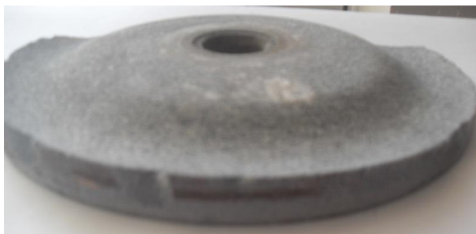
Рисунок 4. Износ круга в процессе обработки
