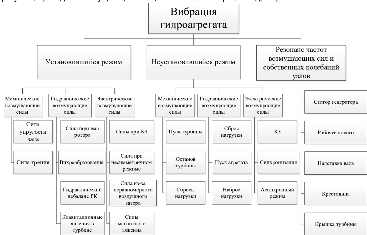
Рисунок 3 – Силы, вызывающие вибрацию гидроагрегата
