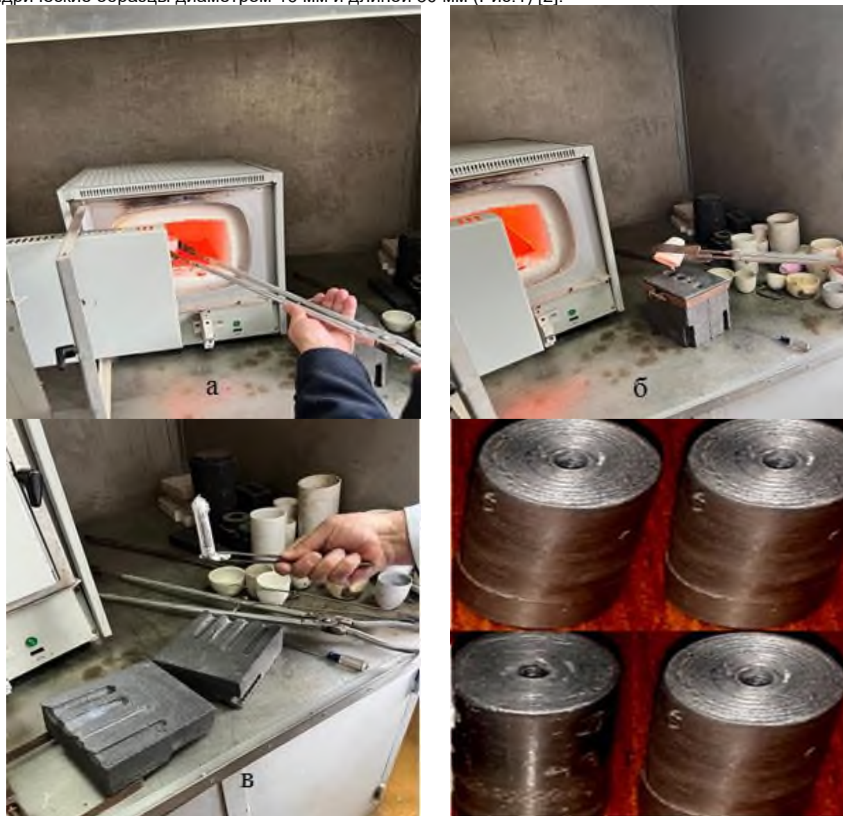
Рисунок 1 – Процесс получения сплавов: а – плавление шихты в муфельной печи; б – литьё образца в графитовой изложнице; в – извлечение образца из изложницы; г – готовые образцы для исследования
