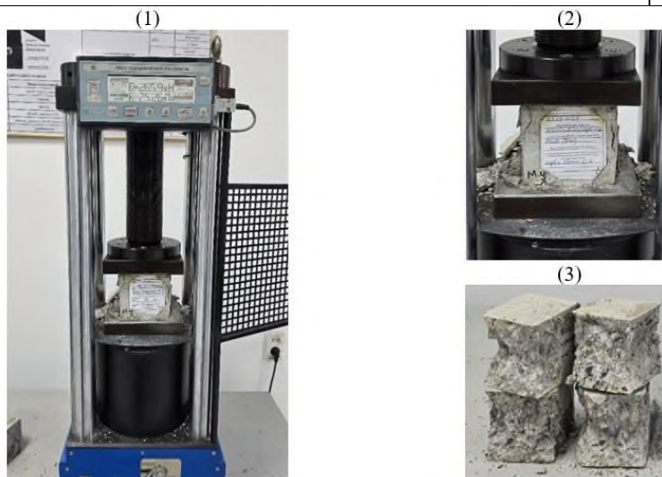
Рисунок 1 – Испытание бетонных кубов (1-гидравлический пресс маркой ПГМ-500МГ4А, 2- разрушения бетонных кубов в момент проведения эксперимента, 3- характер разрушения серии 4-х бетонных кубов)
