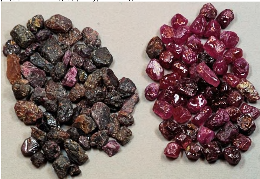
Расми 8 – а) ёқут то коркард ва б) баъд аз коркарди ҳароратӣ
