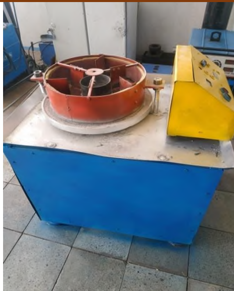
Рисунок 3 – Станок для формообразования шариков из самоцветных камней
