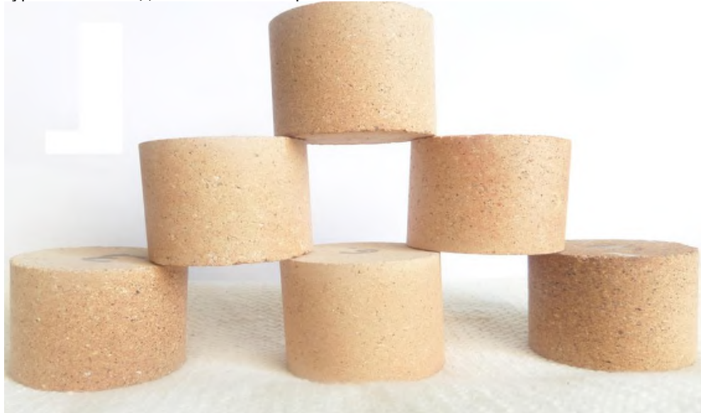
Рисунок 2 — Опытные образцы огнеупорных глин в виде цилиндрических стержней (размер 40х50мм)
