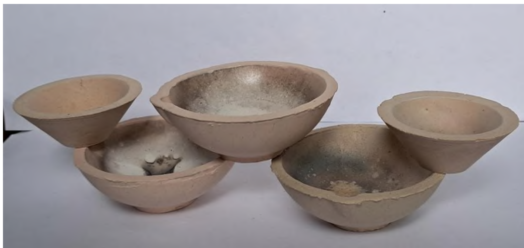
Рисунок 3 — Огнеупорные тигли для плавки драгоценных металлов из глины Шишкатского угольного месторождения
