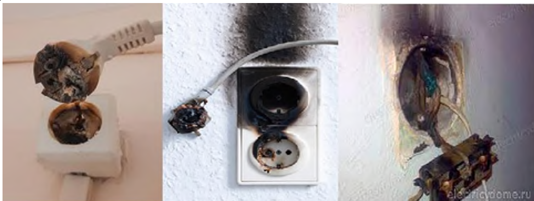
Расми 2 - Оқибатҳои нодуруст истифода бурдани душоҳа ва вайроншавии тамосҳои электрикӣ
